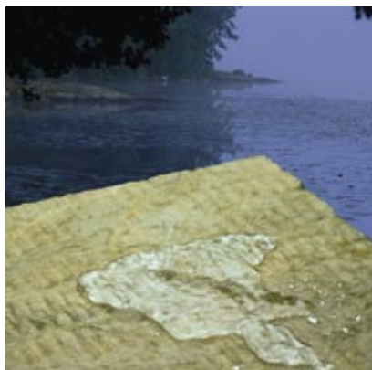
Базальтовая вата PAROC – материал некапиллярной природы и не впитывает воду.
