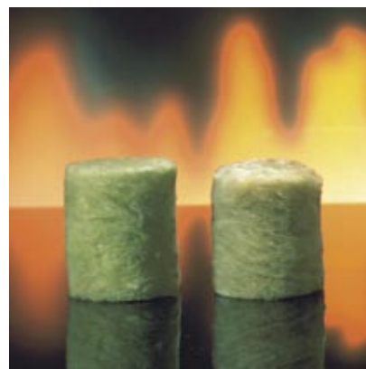
Слева образец базальтовой ваты до испытания на огнестойкость, справа - после испытания.
